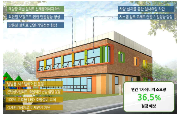
< 국·공립어린이집 그린 리모델링 >
